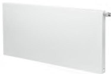
Радиаторы этого типа имеют абсолютно гладкую переднюю пластину с легкими горизонтальными бороздками. Приборы снабжены боковыми накладками и верхней накладкой типа «гриль». Благодаря наличию четырех присоединительных отверстий с внутренней резьбой G 1/2" возможно осуществление подключения радиатора, как справа, так и слева.
