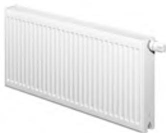
Это панельный стальной радиатор с рифленой передней панелью. Подключение боковое — четыре выхода с внутренней резьбой 1/2". Выпускается следующих типов: 11, 21, 22, 33. Первая цифра обозначает количество панелей, по которым бежит теплоноситель, вторая — количество дополнительных конвекционных панелей.
